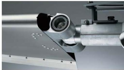
為了讓大型葉片能夠順利旋轉，採用獨家開發而成的鋁製輪轂和螺栓，這些全部都是從鋁塊切削出來，非常堅固。同時，也使用了能吸收振動的材料，將輪轂承受到的壓力降低至 50~75%。另一方面，一般而言輪轂幾乎都是鑄造品，雖然能夠降低成本，但內部卻有許多孔，反而容易龜裂等。
